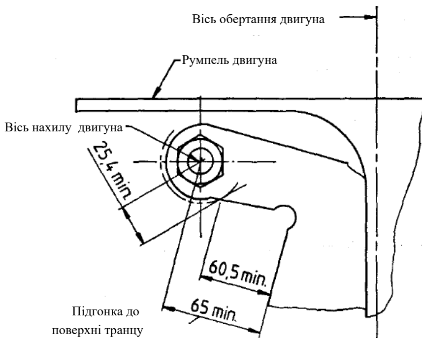
Рис. 2.14.4.2.2-2. Розташування осей системи, що встановлюється на двигуні
